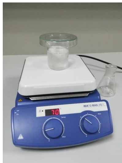
Slika 4. Otopanje polistirena u toluenu uz pomoć mješalice IKA C-MAG HS 7
