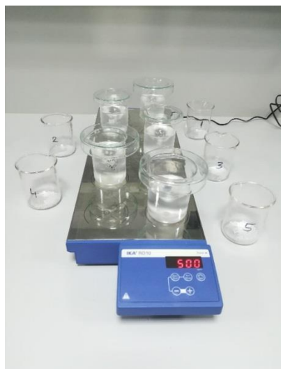
Slika 3. Otopanje polistirena u toluenu uz pomoć multipozicijske mješalice IKA RO 10
