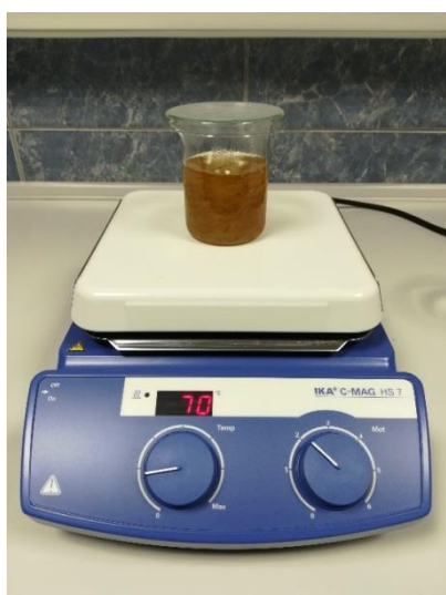
Slika 5. Otopanje polistirena u toluenu s drvnim brašnom
