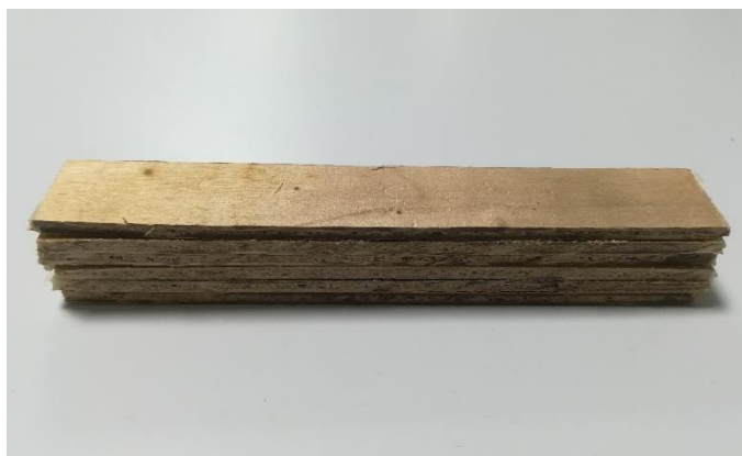
Slika 10. Uzorci drvo-plastičnog kompozita za ispitivanje savojne čvrstoće i modula elastičnosti
