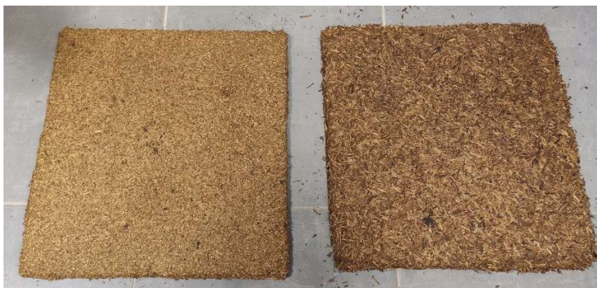
Slika 19. Ploče iverice nakon prešanja u fazi kondicioniranja (sitnije iverje lijevo, krupnije desno)
