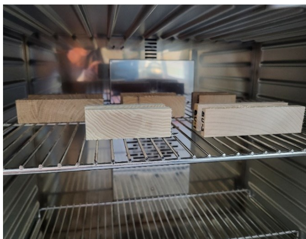
Slika 23. Uzorci "štangica" u sušioniku (foto:Ivanda A., 2024.)
