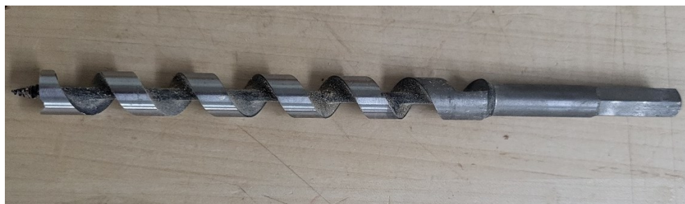
Slika 11. Spiralno svrdlo promjera \phi 16 mm (foto:Ivanda A., 2024.)
