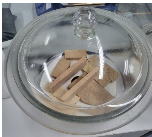
Slika 24. Uzorci "štangica" u eksikatoru (foto:Ivanda A., 2024.)
