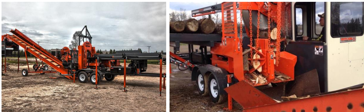
Slika 24. Multifunkcionalni stroj za piljenje i cijepanje ogrjevnog drva Izvor: http://www.multitekinc.com/products/firewood-processors/2020 https://www.youtube.com/watch?v=rA_fU5sACp4
