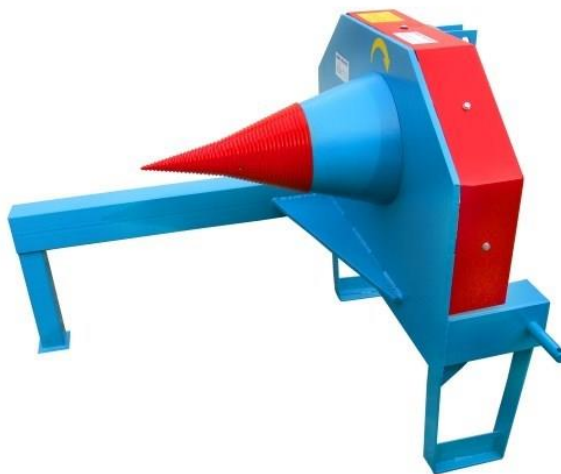
Slika 16. Cjepač na trn (svrdlo)
