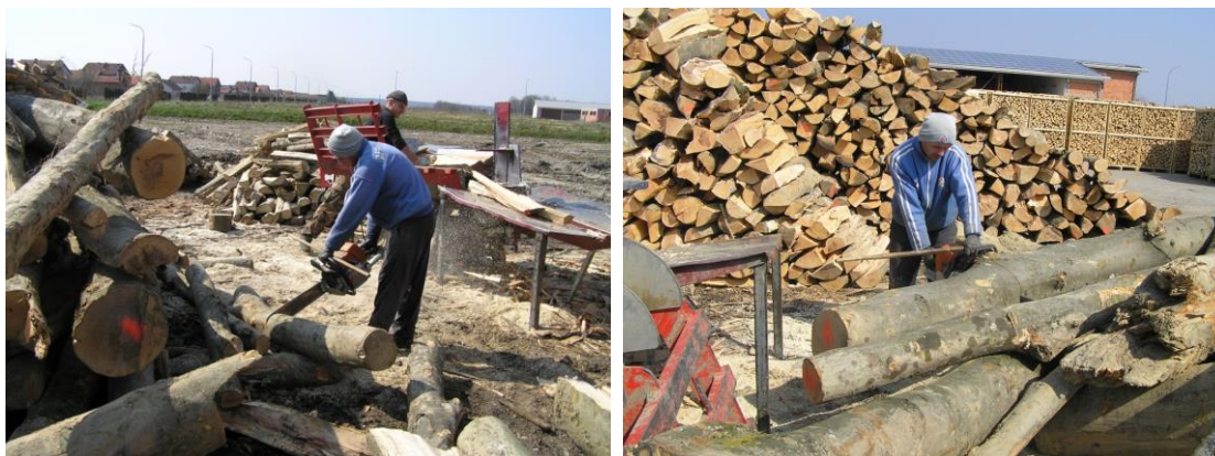
Slika 31. Prikračivanje oble višemetrice motornom lančanom pilom
