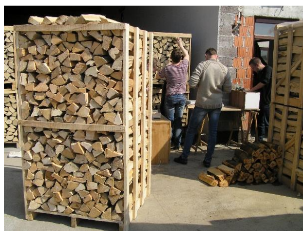
Slika 6. Ostaci (otpac) nakon cijepanja i cijepano ogrjevno drvo složeno u paketu
