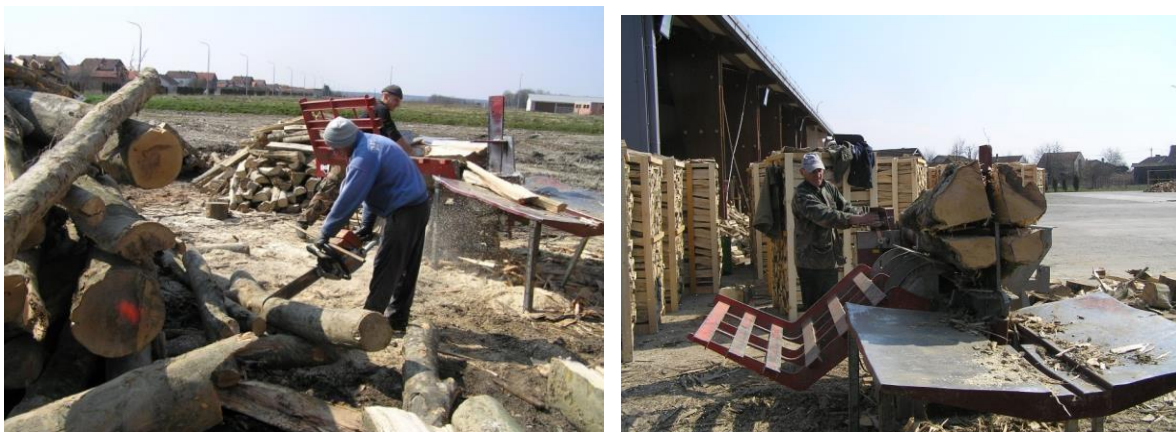
Slika 21. Prikrajanje motornom pilom i cijepanje na hidrauličnom cjepaču
