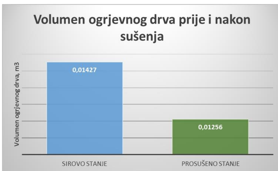
Slika 29. Grafički prikaz promjene volumena ogrjevnog drva prije i nakon sušenja
