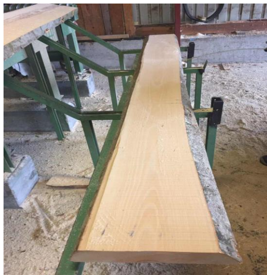
Slika 19. Detalj poprečnog presjeka i piljenica obične bukve
