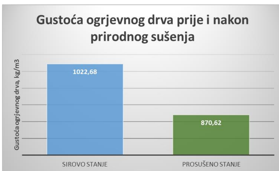
Slika 31. Grafički prikaz promjene gustoće ogrjevnog drva prije i nakon sušenja
