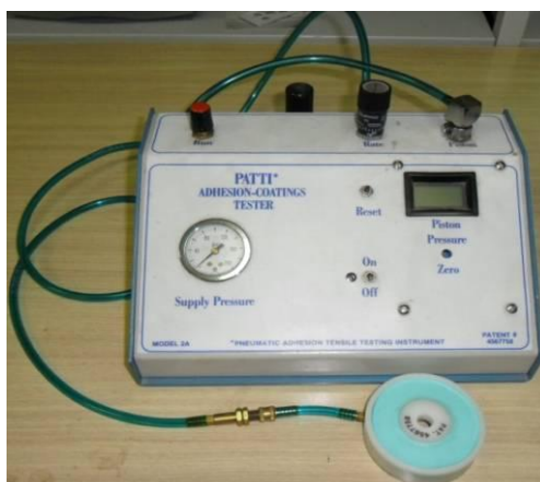
Slika 16. Uređaj za određivanje adhezije metodom otkidanja valjčića (Pneumatic Adhesion Tensile Testing Instrument - PATTI)
