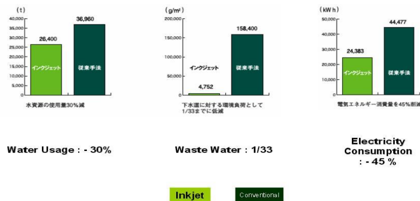
Slika 8: Odnos potrošnje vode, energije i ekološke prihvatljivosti konvencionalnog i digitalnog tiska
