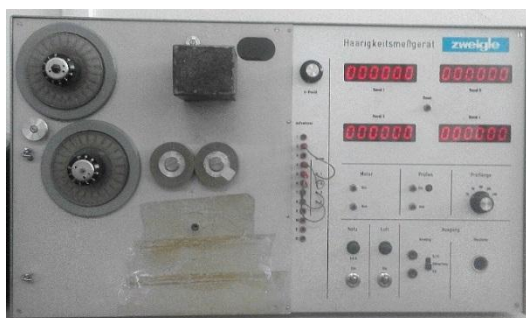
Slika 20. Uređaj za mjerenje dlakavosti tip G 565, Zweigle, Njemačka
