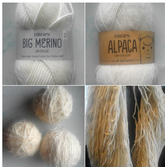
Slika 18. Pređe korištene u radu, gore s lijeva na desno: merino, alpaka, dolje s lijeva na desno: domaća pramenka ručno predna, domaća pramenka strojno predena
