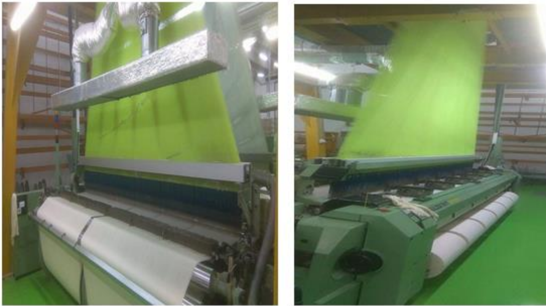
Slika 3 Prikaz stražnje i prednje strane elektroničkog žakarskog stroja Sulzer Ruti sa žakarskim mehanizmom Jumbo Jacquard – Staubli MB 220 u Tvornici tekstila Trgovišće
