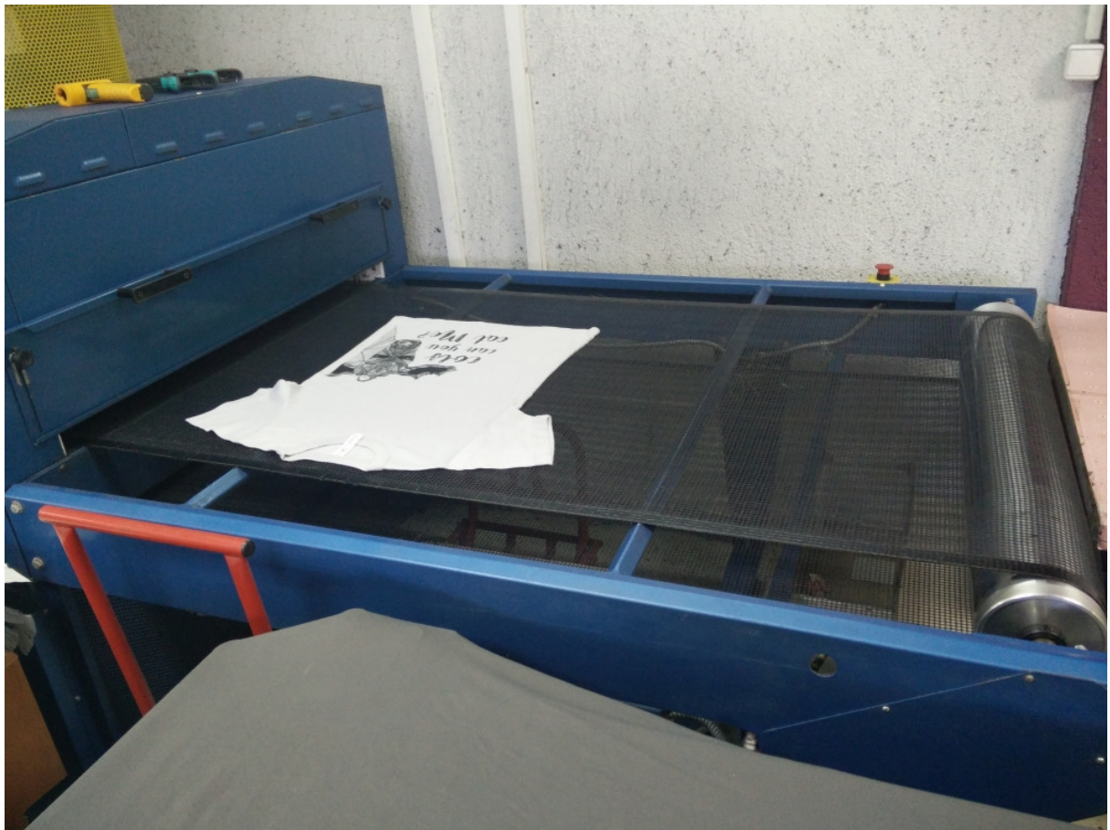
Slika 23: Majica koja prolazi termofiksiranje
