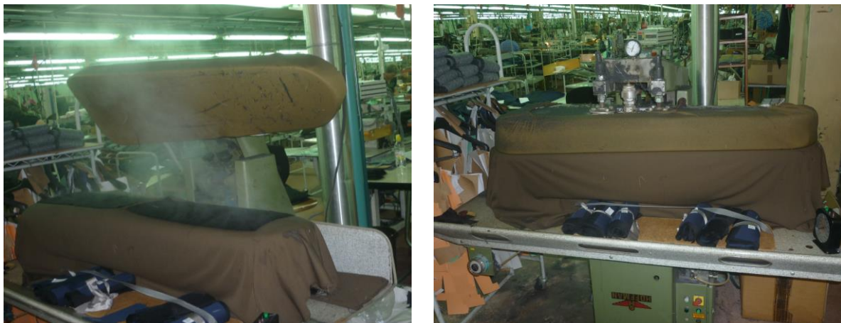
Slika 3.16. Stroj za glačanje (prešanje) marke Hoffman
