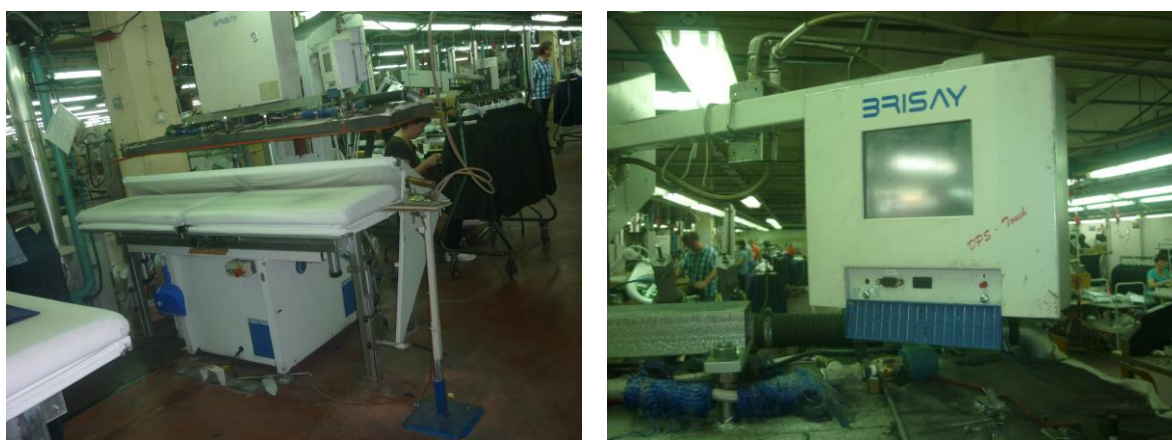
Slika 3.17. Stroj za glačanje (prešanje) marke Brisay
