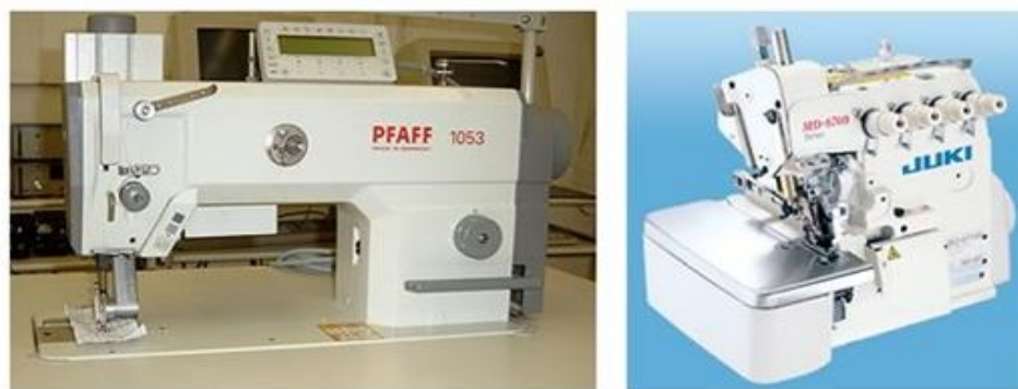
Slika 2.31. Šivaći strojevi: a) univerzalni šivaći stroj; b) specijalni šivaći stroj
