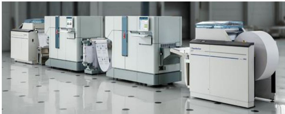
Slika 1: Sustav digitalnog tiska na pamučni tekstilni materijal
