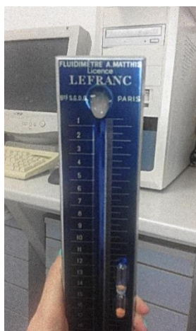
Slika 23. Fluidometar A.Mathis BTE S.G.D.G (Pariz, Francuska)
