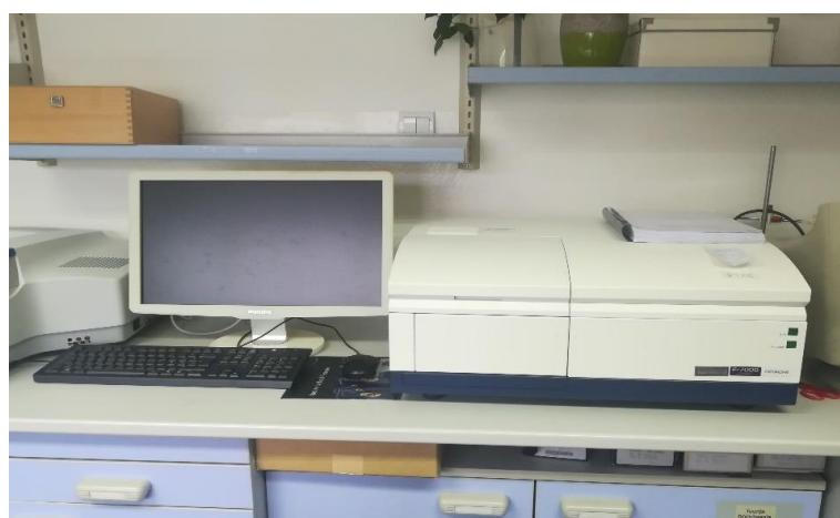
**Slika 11:** Aparat za mjerenje relativnog intenziteta fluorescencije
