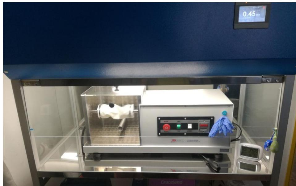
**Slika 7.** Generator tekstilnih čestica s mjeračem veličine čestica od 0,3 do 25  $\mu\text{m}$
