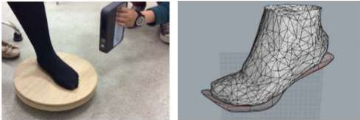
Sl.9. (lijevo) 3D skeniranje; (desno) 3D modeliranje [12]
