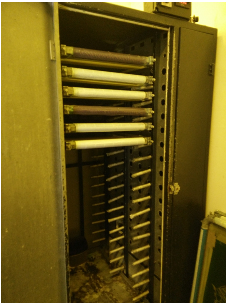
Slika 15: Sušilo za sita
